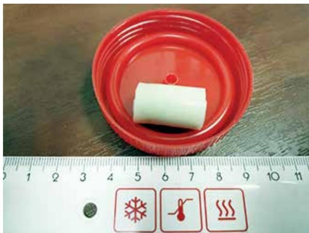
**Рис. 1.** Цилиндрический образец цемента, смешанного с антимикробным препаратом
