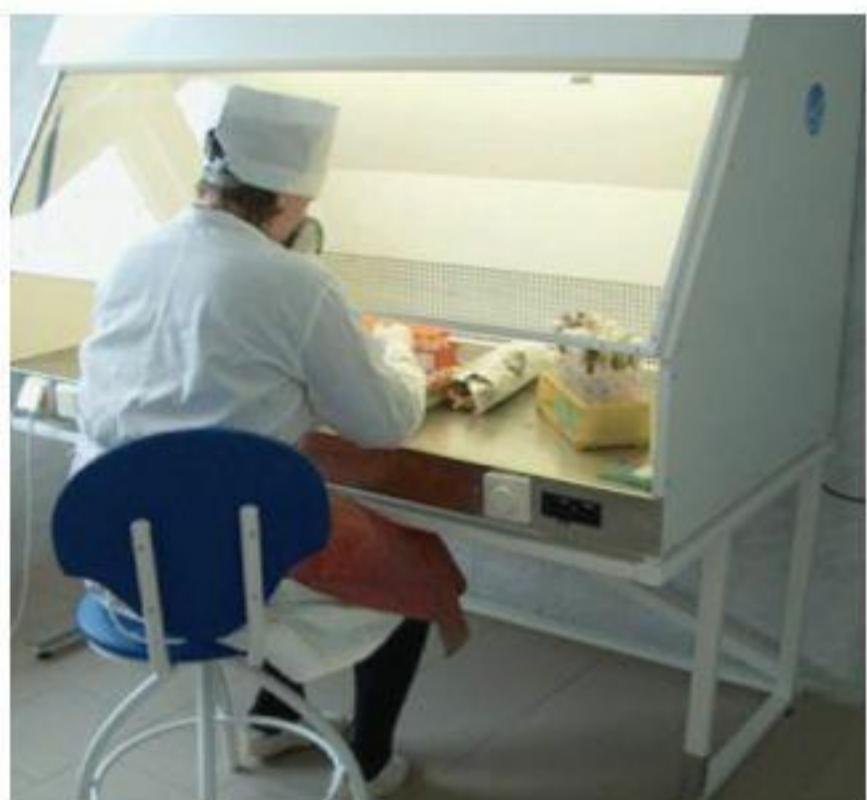
Рис. 4. Лабораторные манипуляции, сопровождающиеся риском образования аэрозолей, с использованием боксов микробиологической безопасности (стандарт EN 12469) и сертифицированных респираторов (стандарт EN 149)
