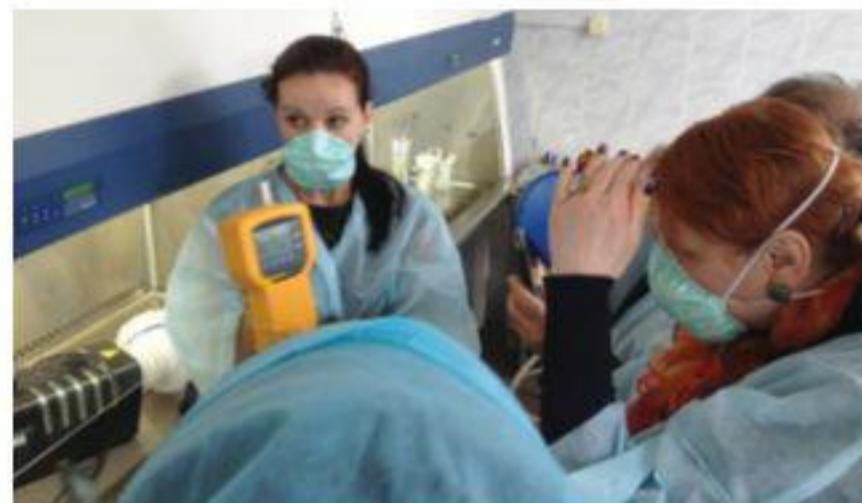
Рис. 8. Упражнение по тестированию боксов микробиологической безопасности в программе курса по биобезопасности на базе демонстрационного Центра по противотуберкулезному контролю
